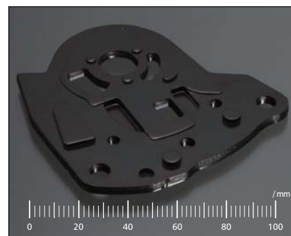
材質 SPH590 従来工法 FB 板厚 T=4.5 新工法 順送 特徴 順送金型による複合成形
