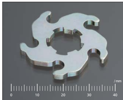
材質 NFBS150 従来工法 — 板厚 T=2.6 新工法 順送 特徴 せん断面100% 輪郭度0.05以下
