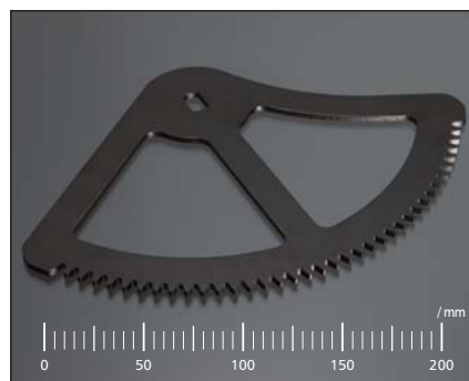
材質 SPH780 従来工法 FB 板厚 T=3.2 新工法 順送 特徴 難加工材のシェービング加工
