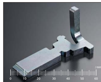
材質 SCM435 従来工法 熱間鍛造+切削 板厚 T=6.0 新工法 PRG+精密せん断工法(単発) 特徴 板厚6.0の精密打ち抜き加工
