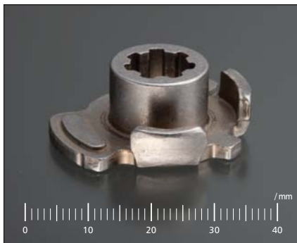
材質 SPCD 従来工法 焼結 板厚 T=2.3 新工法 順送 特徴 絞り高さ11.6、増肉2.3→3.15
