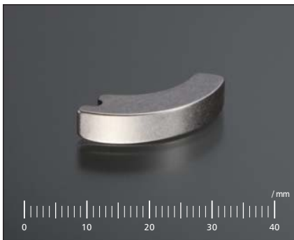
材質 SCM415 従来工法 鍛造+研磨 板厚 T=5.0 新工法 順送+単発(シゴキ抜き) 特徴 切り口面表面粗度Ra0.4以下
