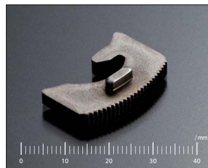
材質 S22CB 従来工法 FB 板厚 T=3.2 新工法 精密せん断工法(PRG) 特徴 ギアの精密打ち抜き加工
