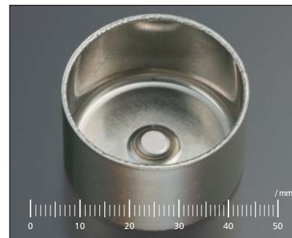
材質 SCM415 従来工法 鍛造・絞り 他 板厚 T=3.0 新工法 絞り・コイニング・シゴキ抜き複合加工 特徴 外径円筒度0.03 真円度0.02
