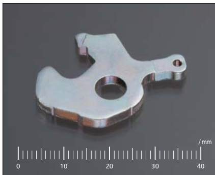
材質 SPFH590 従来工法 FB 板厚 T=2.9 新工法 順送 特徴 せん断面80%
