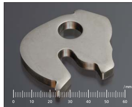
材質 SCM435 従来工法 FB 板厚 T=6.0 新工法 精密せん断工法(1ショット加工) 特徴 せん断面100%・切り口面直角度0.05
