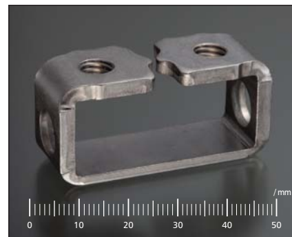
材質 SPH590 従来工法 — 板厚 T=3.6 新工法 順送(コイニング・シェービング・曲げ複合加工)+単発 特徴 コイニング T=3.6 → T=2.2
